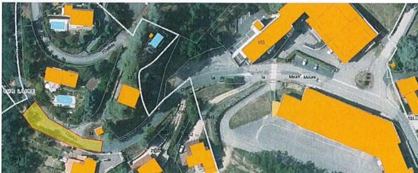
La voie sera rétrécie sur la largeur d'une demi-chaussée au droit des travaux. L'entreprise GALLOT mettra en place un alternat par feux tricolores. En aucun cas la voie ne sera fermée à la circulation des automobilistes et des piétons pendant les travaux.
