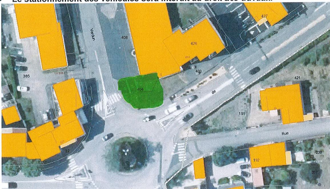
La voie sera rétrécie sur la largeur d'une demi-chaussée au droit des travaux. En aucun cas la voie ne sera fermée à la circulation des automobilistes et des piétons pendant les travaux. L'entreprise CUERQ accédera à la zone des travaux par l'Avenue de Verdun.
